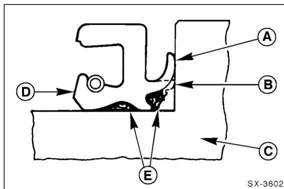
A – Dichtlippe neu, B – Dichtlippe verschlissen, C – Radnabe oder Gelenkwelle, D – Dichtring, E – Fett.
