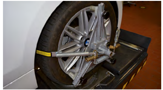
Bild 2: Halter für Messwertaufnehmer am Rad montiert
