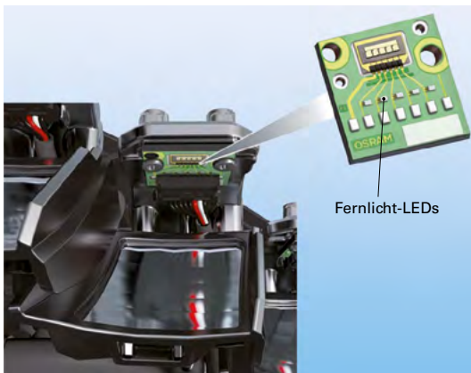
Bild 2: Platine mit Fernlicht-LEDs
