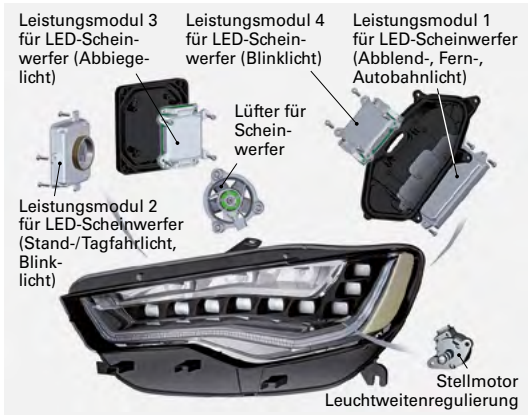
Bild 1: Aufbau Scheinwerfer in LED-Technik
