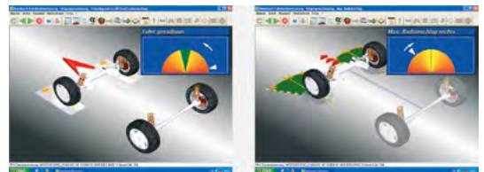
Bild 4: Ermittlung der Spurwerte
