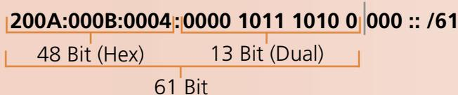
Die letzten drei dargestellten Bits werden zur Unterscheidung der Subnetze herangezogen. Insgesamt können in diesem Fall demnach 8 Subnetze unterschieden werden.
