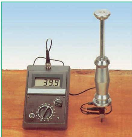
Bild 20.3: Holzfeuchtemessgerät mit Rammsonde
