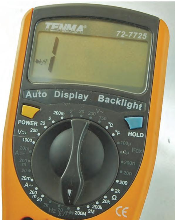
Abb. 1.8: Multimeter im Modus als Durchgangsprüfer
