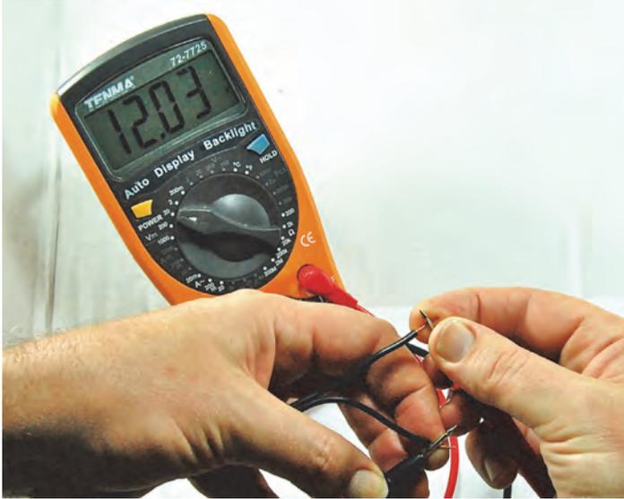
Abb. 1.13: Feststellen der Polarität mittels Multimeter
