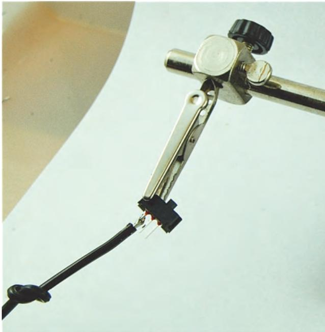
Abb. 1.15: Verbinden der positiven Leitung mit dem Schalter
