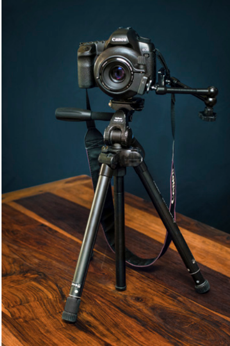
Abb. 5-22: Das System für die Frankfurt-Fotos mit ausgeprägtem Schärfeverlauf besteht aus Stativ, Body 5D Mark II, Tilt-Shift-Aufsatz (nach Kapitel 1.2) und Objektiv EF 50 f/1.8 II. Nicht im Bild ist die hilfreiche Kinotechnik-Displaylupe.
