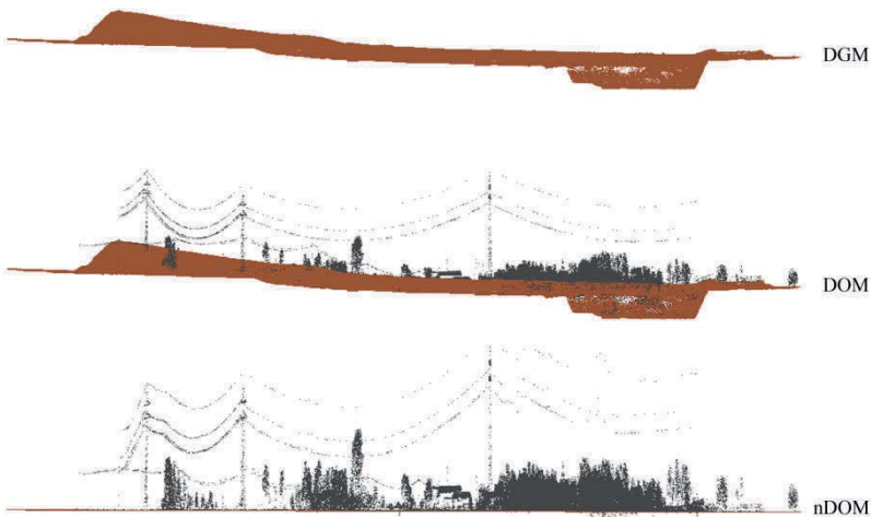
Abb. 19.1: Darstellung der Derivate DGM, DOM und nDOM aus LiDAR-Daten (Quelle: WICHT 2012)
